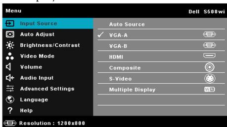
**VGA-A**—Pressione para detectar um sinal VGA-A.
