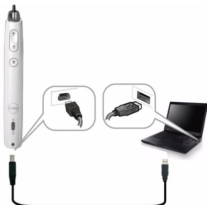
Quando a carga estiver finalizada, você pode desconectar o cabo mini USB (ou manter o cabo conectado e utilizar a Caneta Interativa enquanto ela está carregando).
