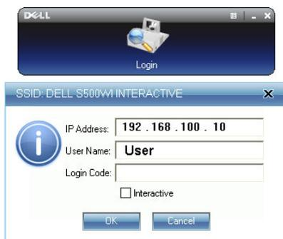
**NOTA:** Se o IP Address (Endereço IP) não for detectado, insira o IP Address (Endereço IP) no canto inferior esquerdo da tela.
