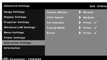
**POINTER MOTION (MOVIMENTO DO PONTEIRO)**—Permite que você selecione o modo Pointer Motion (Movimentação da Ponteira): Normal, Draw (Puxar) e Stable (Estável).
